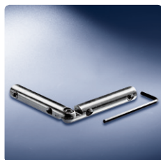
36.1295.01 Schienenverbinder 2D mit vertikalem Gelenk Stahl verzinkt Inkl. 6-Kant-Schlüssel Zur Verbindung von auf Gehrung geschnittenen Schienen mit individuellen Winkeln \geq 60^\circ
